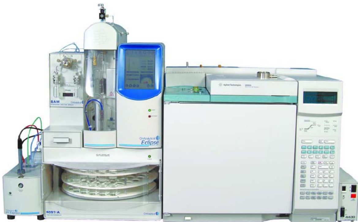
图 1 马萨诸塞 VPH 方法的仪器配置包括一台 OI 分析仪器公司的 Eclipse 样品浓缩仪、4551A 型自动进样器、SAM、pH Express 和一台配置了 4450 型串联式 PID/FID 检测器的 Agilent 6890 气相色谱仪。图 1 显示了系统的所有装置。
