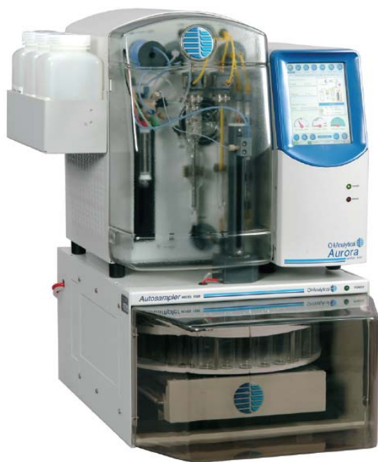
图 1 Aurora 1030W TOC 分析仪和 1088 自动进样器
